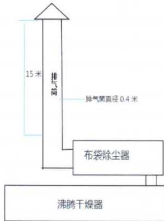
图 3-4 固体制剂喷雾干燥器废气处理工艺流程图
