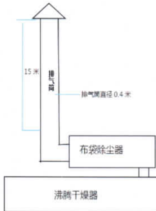
图 3-7 固体制剂沸腾干燥器废气处理工艺流程图
