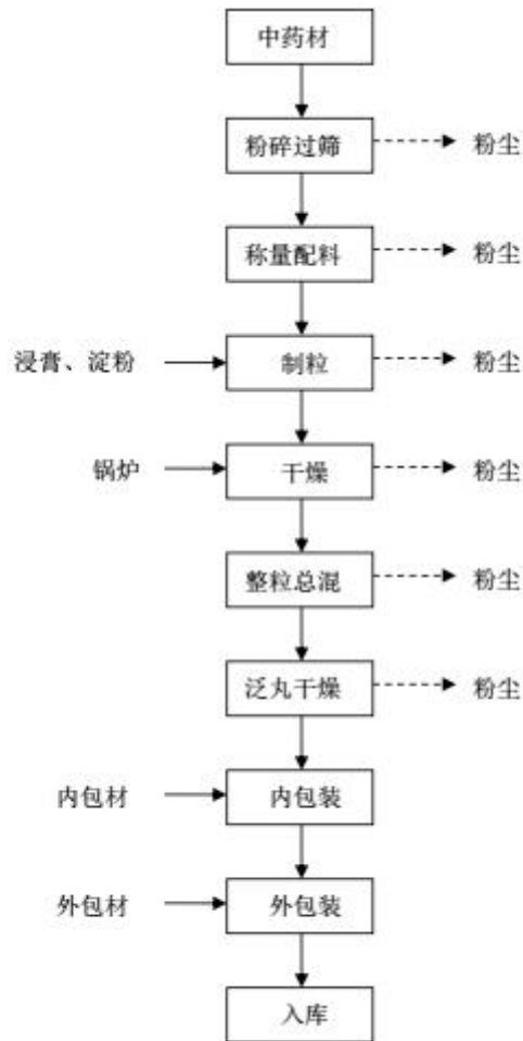
图 1-3 丸剂生产工艺及产污环节图
