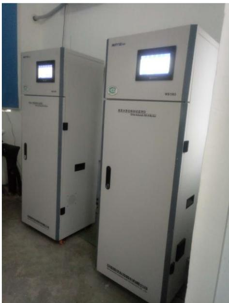
CODcr 和氨氮水质在线自动检测仪
