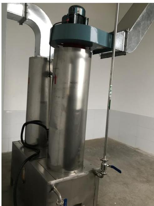
炒药工序双塔式废气处理装置
